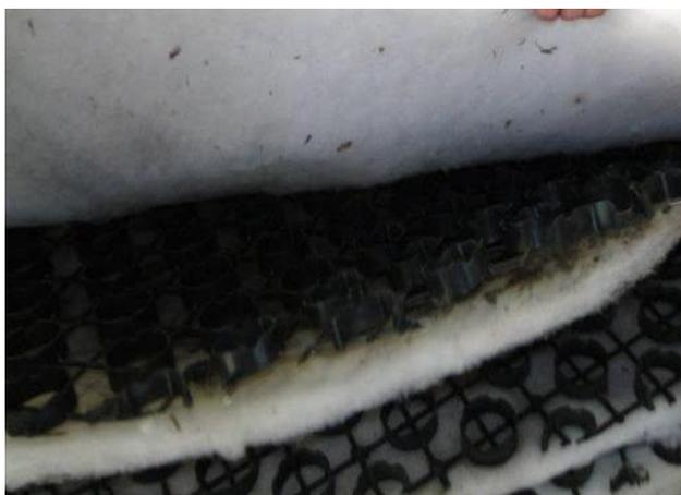
**Figura 2:** Camadas de Membrana Fibra PC e Grelhas de Ecopavimento.
