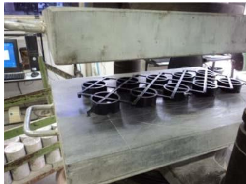
Foto 04 – Compressão do Ecopavimento sem preenchimento
