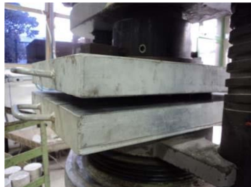
Foto 02 – Compressão do Ecopavimento preenchido com areia
